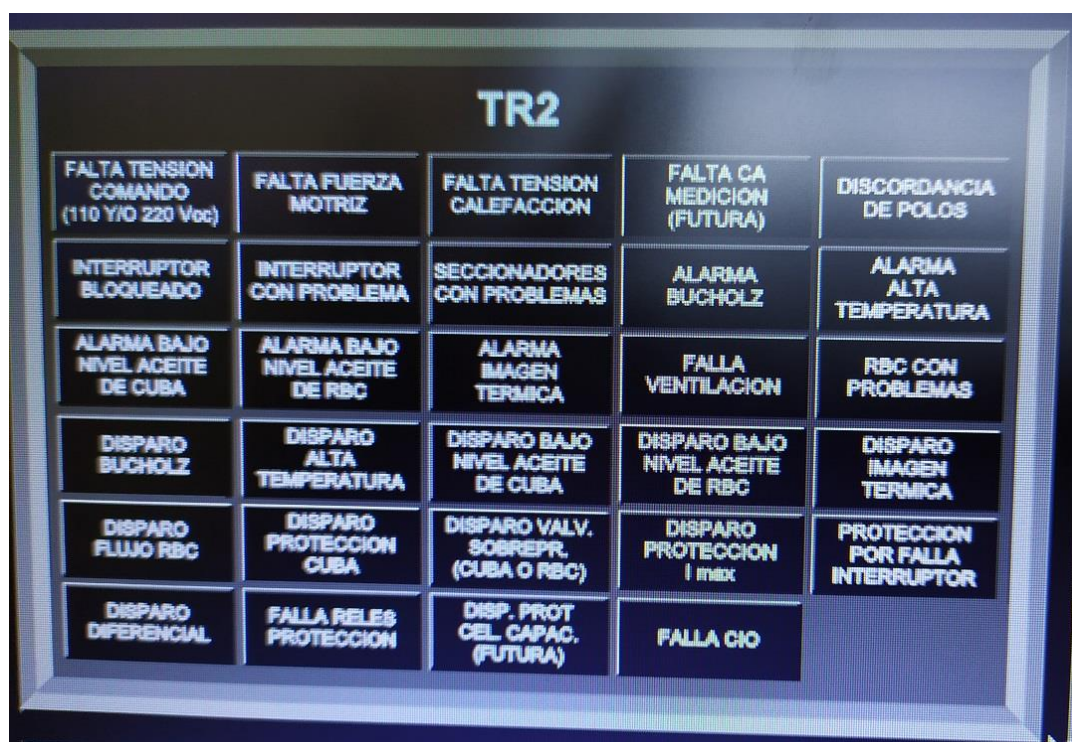
Figura 7. Detalle alarmas campo Transformador 132/33/13,2 kV.
